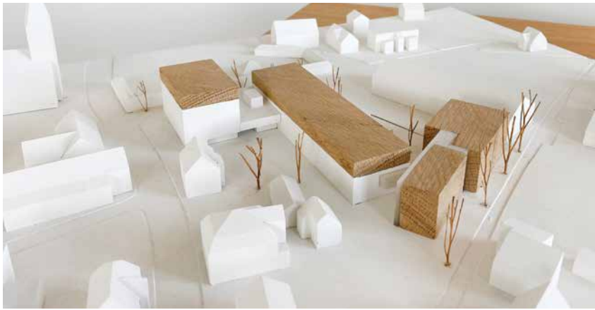
Das Modell zeigt die Aufstockung des Rathauses, welches zurückgestellt wurde und die Aufstockung der bestehenden SeneCura mit bebauter Terrasse und die zusammenhängenden Gebäude 3a und 3b
